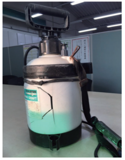
加圧中に破損した噴霧器
