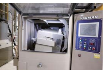
籾すり機 籾から籾殻を取り除いて玄米にします。
